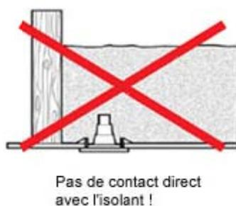
**Figure 2 : Spot encastré non protégé interdit dans l'isolation**
