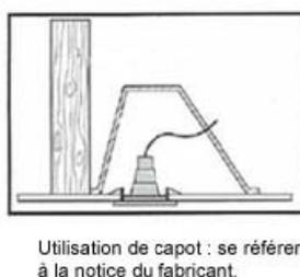
**Figure 3 : Spot encastré protégé à l'aide d'un capot évalué conformément au CPT 3693 V2**
